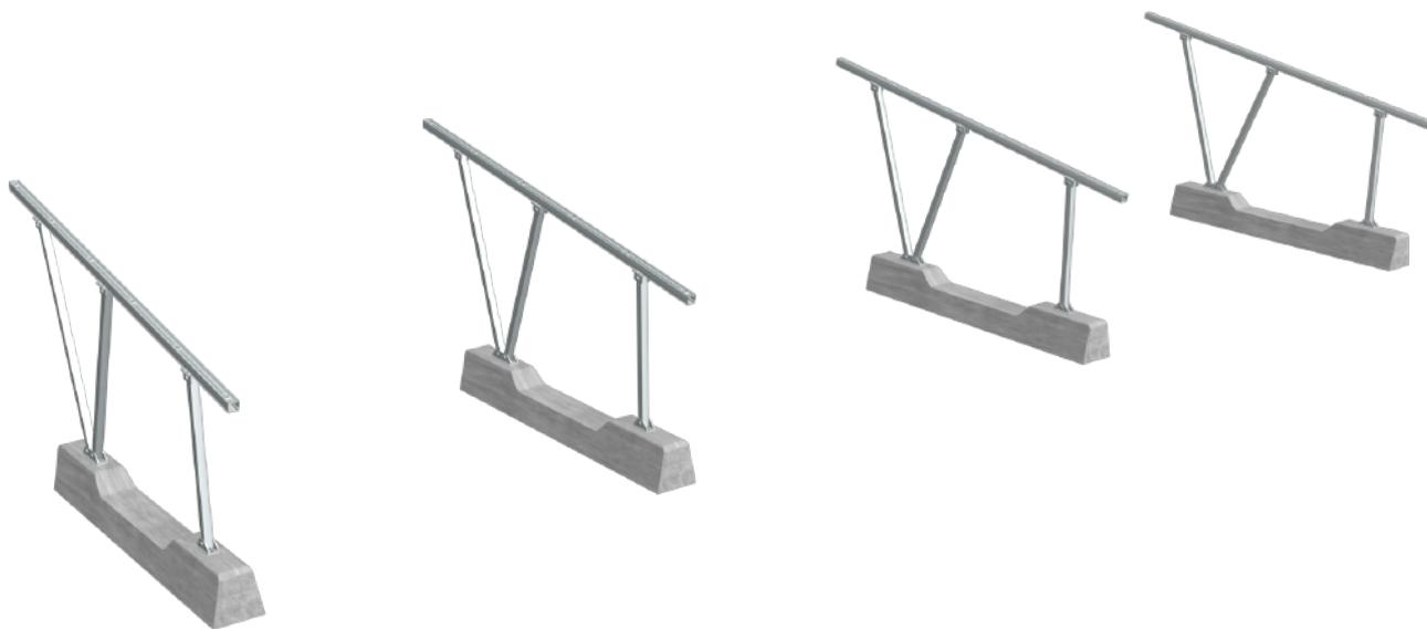
1.2(e)重复以上步骤，按照图纸要求，将车棚支架安装在水泥基础上如上图所示。
