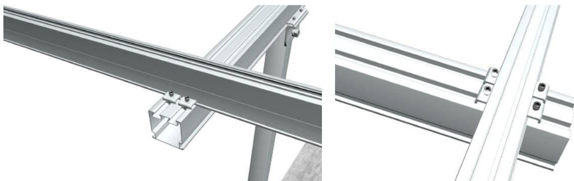
2.5用C形压块将轨道115 固定在预装支架上，用6mm内六角扳手锁紧M8 内六角螺栓。注意：轨道两边各2套C 形压块组件。
