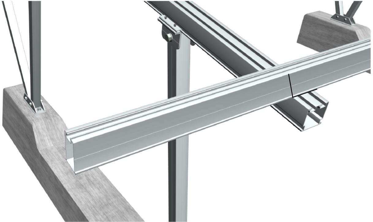
2.3按照工程图的尺寸，在轨道上端面到纵梁边缘的位置上用彩色笔标记以及在纵梁110 上标记出轨道边缘的位置。同样可以标出纵梁上轨道边缘的位置，以便轨道放置。
