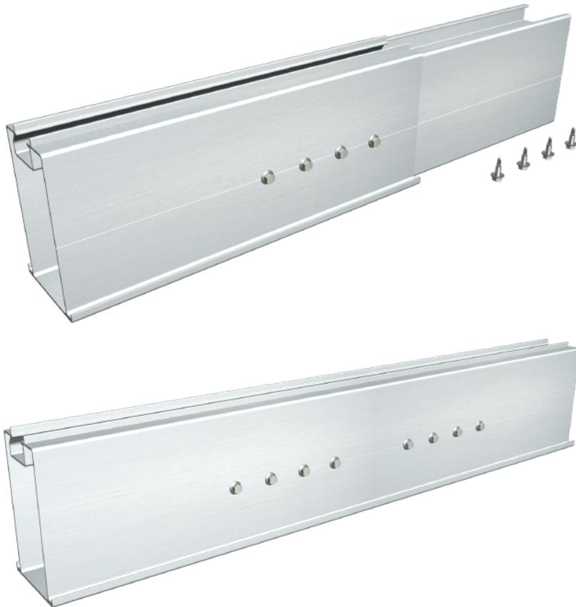
2.2在将轨道115 安装到预装支架上前，请先确认所需轨道115 的长度。如果不够长请用轨道115 连接件进行连接。单侧8 枚自攻螺钉，总共需要打16 枚自攻螺钉。不推荐在预装支架上进行轨道连接。
